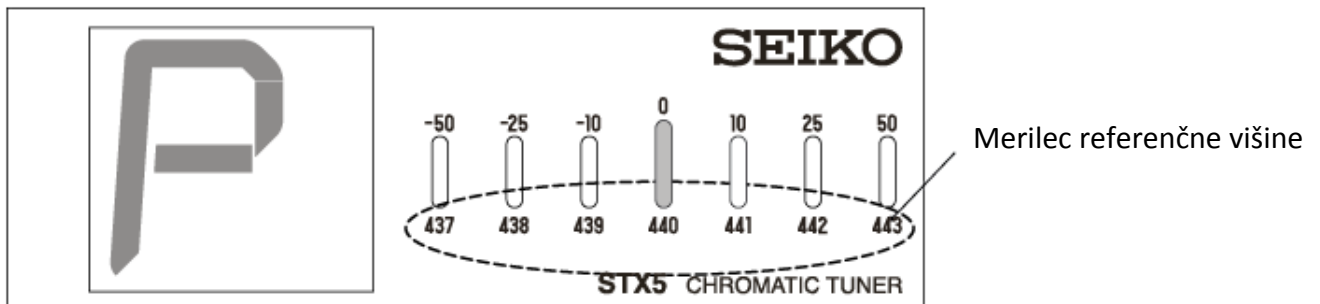
Zaslon ob nastavljanju referenčne višine (prikaže se 440Hz)
